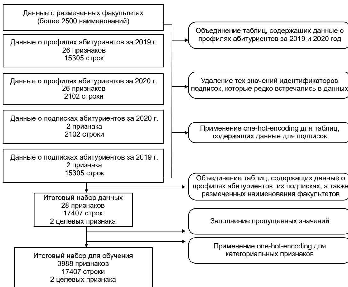
Рис. 1. Схема сбора и обработки данных для обучения моделей
